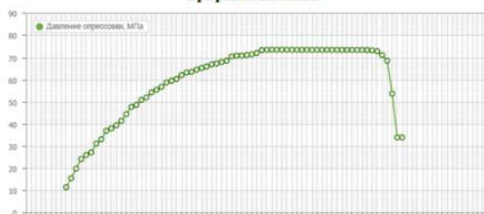
Рис.5. Графики гидравлических испытаний сборки на 69 МПа и 30 МПа
