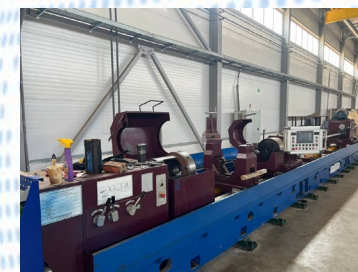
Станок глубокого сверления ВТА Глубина сверления и расточки до 4 м
